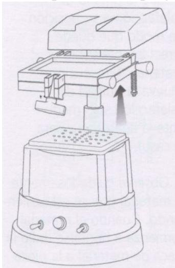
4. Placer le moulage (gypse, pierre dentaire etc.) sur la plaque d'aspiration. La Machine III peut fonctionner avec un ou deux moules de taille moyenne. Dans le cas où deux moules sont utilisés, les placer sur la plaque d'aspiration dos-à-dos en diagonale et en les espacant légèrement.
