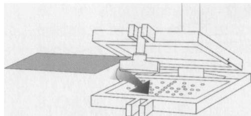
3.- Coja el marco por las dos asas traseras y élévelo hacia la resistencia hasta que note un clic de ajuste, y vea que queda sujeto. Se sube mediante las dos asas de atrás.
