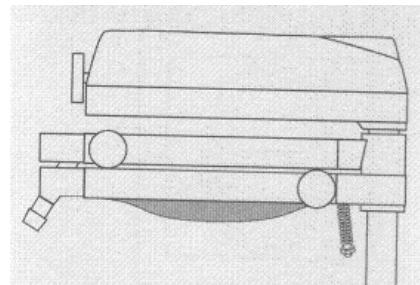
En las máquinas nuevas los tornillos que sujetan el marco al eje vertical pueden estar muy apretados, haciendo que se agarre al subir y bajar el marco, o muy flojos evitando que el marco quede sujeto arriba. Se puede ajustar fácilmente.
