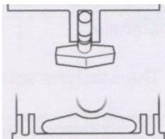
3. Attraper les deux poignées situées à l'arrière de la plaque inférieure et relever les deux plaques ensemble, jusqu'à ce que la position chauffage s'enclenche.
