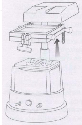
4.- Coloque el modelo o modelos en la superficie agujereada. El aparato admite 1 (ó 2 pequeños, si pone dos, se deben colocar diagonalmente, con una ligera separación entre ellos). Los modelos deben estar recortados y con la base plana. Para placas rígidas hay que aliviar las retenciones del modelo, de este modo poder separarlo del plástico. Esto se hace con Pasta refractaria Dentaflux. Puede hacerse una perforación en la parte palatal del modelo para aumentar la succión.
