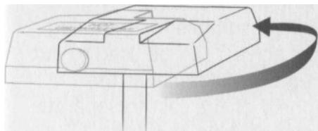
1.- Gire la mampara superior, donde se aloja la resistencia, hacia atrás y encienda la resistencia (botón heater). El aparato necesitará unos 3 minutos para calentarse. Mientras se produce Ud. Realiza los pasos 2 a 5. El piloto indica si la resistencia está conectada o no.
