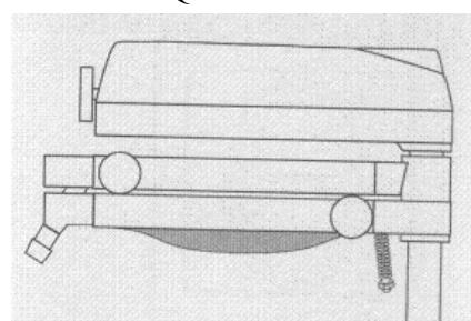
6. Surveiller attentivement le chauffage du matériau. Quand le matériau commence à s'affaisser, abaisser la plaque sur le moulage qui se trouve sur la plaque d'aspiration. (Utiliser les poignées situées à l'arrière de la plaque sur laquelle se trouve le matériau.)
