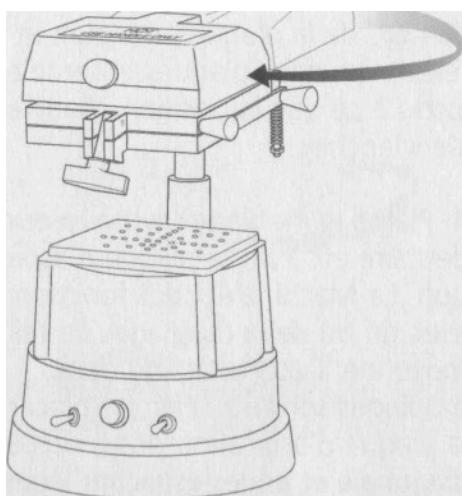
5. Renverser complètement l'unité de chauffage au-dessus du matériau. (Attention : manipuler l'unité de chauffage uniquement en utilisant les pignées destinées à cet effet.)
