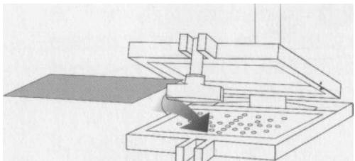
Placer la feuille de matériau de moulage sur la plaque inférieure. Abaisser la plaque supérieure et fermer le loquet.
