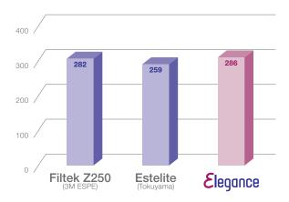
• Resistencia a fractura por flexión (MPa)
